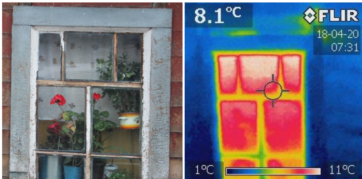
Фото 2 - Тепловизионное обследование объекта эксперимента
