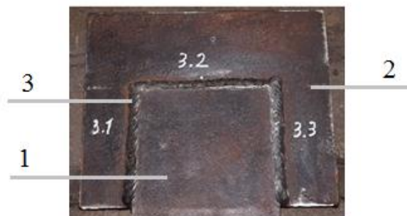
Рисунок 3- Общий вид сварного шва сопряжения полки гнутого уголка с закладной деталью: 1 – накладка (гнутой уголок), 2 – закладная деталь, 3 – сварной шов
