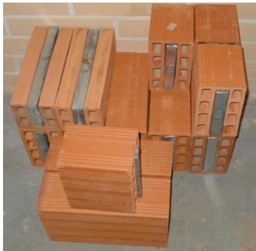
Фото 5 – Керамический блок с заполнением центральной полости макрокапсулой с МИФС [36, 65]
