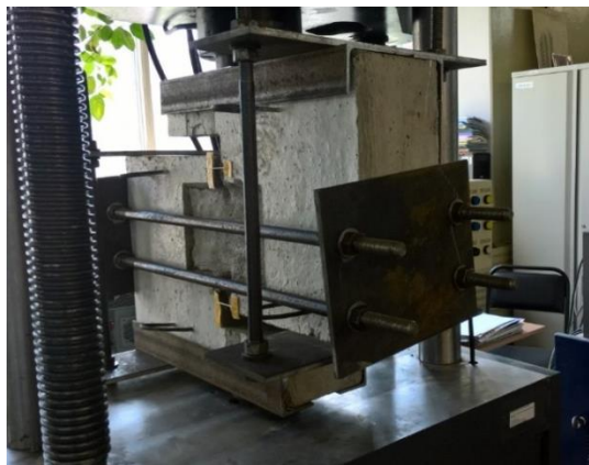
Рисунок 2 – Натурный образец сварного обетонированного стыка
