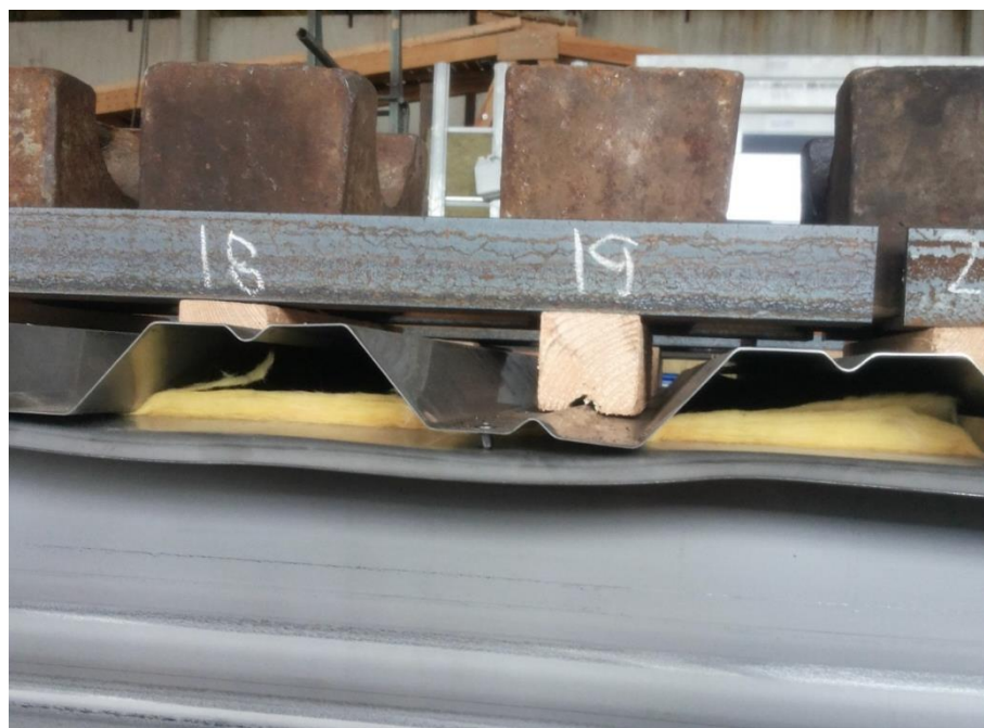
Рисунок 3 – Потеря устойчивости сжатой узкой полки кассетного профиля краевой зоны панели и разрушение соединения на вытяжной заклепке. Этап нагружения 6.
