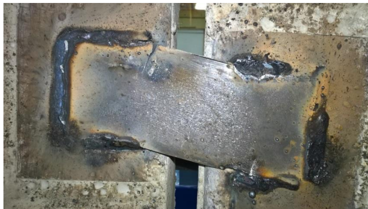
Рисунок 3 – Разрыв пластины в предельной стадии разрушения
