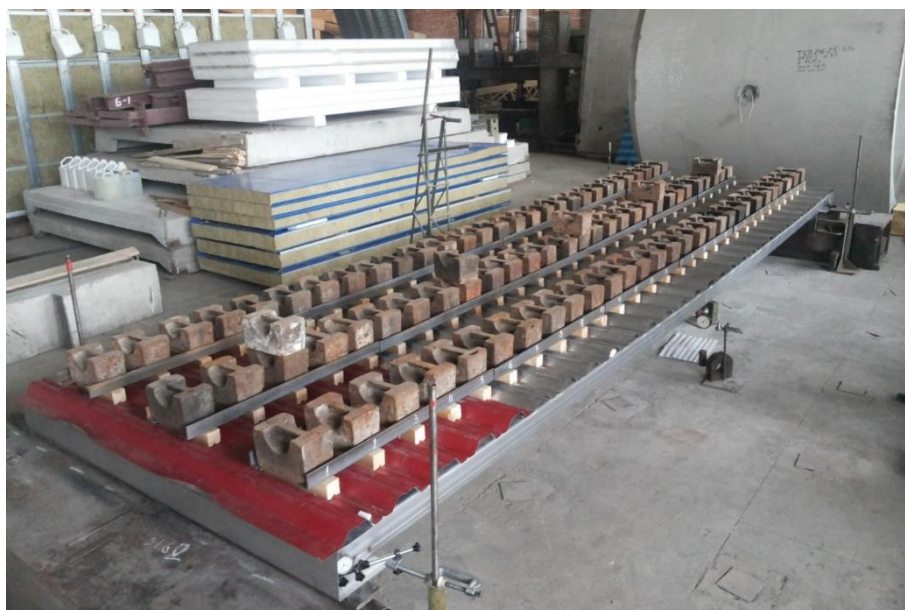
Рисунок 2 – Общий вид схемы испытания панели по схеме А. Этап нагружения 8*.
