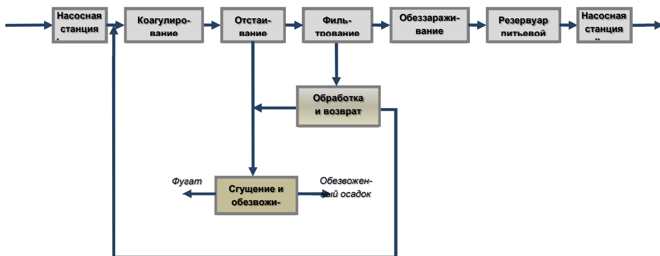
Рисунок 1 – Традиционная технологическая схема очистки природной воды
