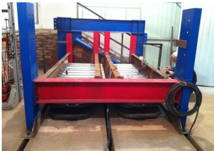
а) опорные конструкции и пневматическая система нагружения
