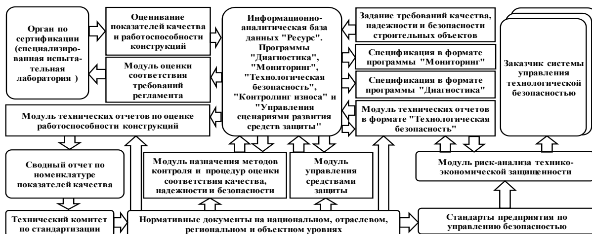
Рисунок 4 – Организационно-методическая схема управления технологической безопасностью строительных объектов
