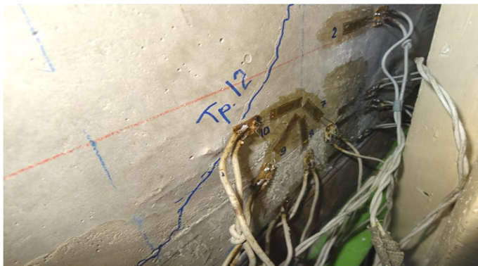
Рисунок 3 – Общий вид установки электротензорезисторов на бетон
