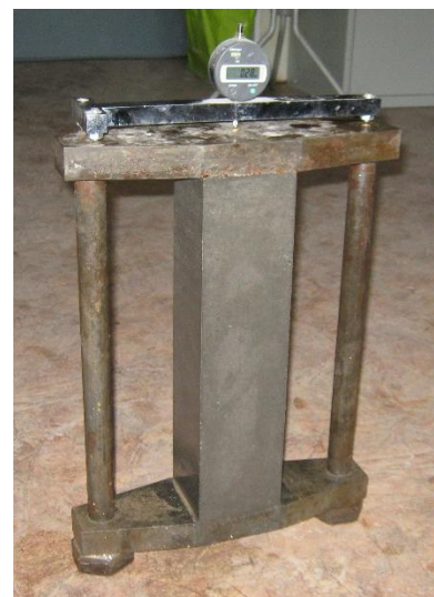
Рисунок 3 – Общий вид динамометрического кондуктора для измерения величины самонапряжения бетона
