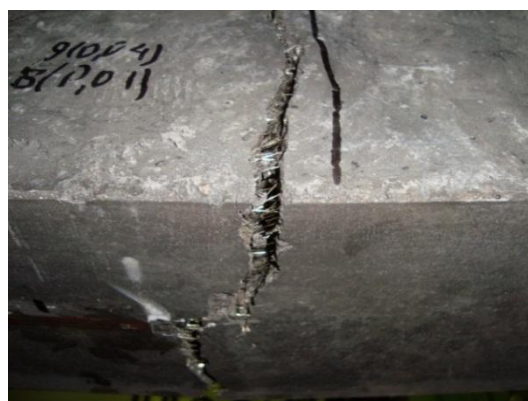
Рисунок 11 – Общий вид разрушения моделей группы 3, выполненных из высокопрочного фибробетона
