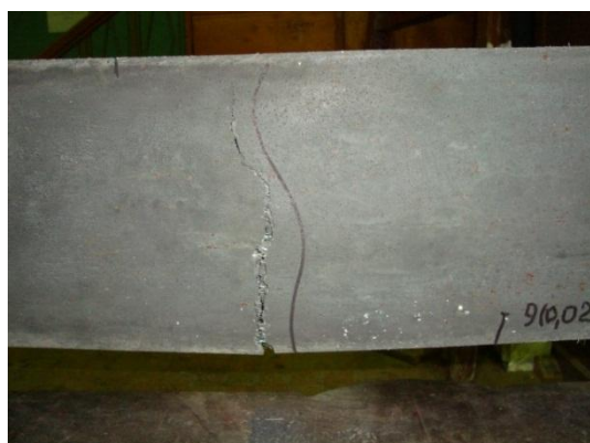
Рисунок 11 – Общий вид разрушения моделей группы 3, выполненных из высокопрочного фибробетона
