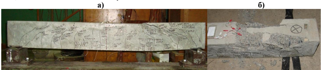
Рисунок 8 – Разрушение моделей группы 1, выполненных из высокопрочного бетона: а)общий вид, б) скол бетона защитного слоя
