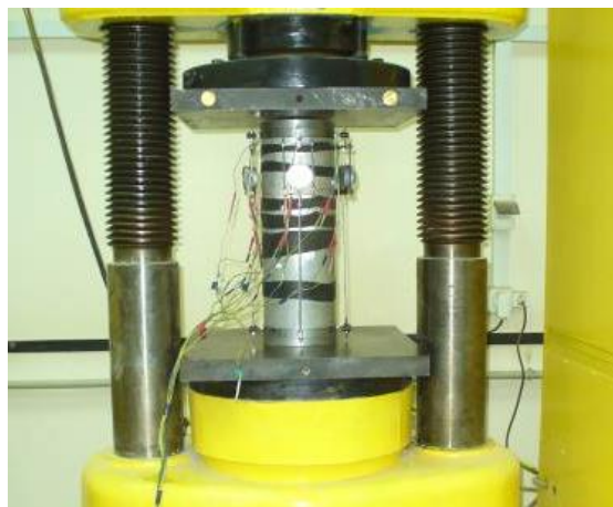
Рисунок 1 - Устройство, используемое при исследовании полных диаграмм деформирования МВБ и ВСФБ [13]
