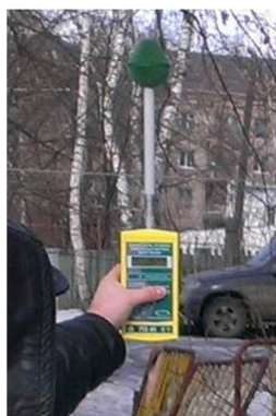
Рисунок 2 - Общий вид исследованного участка, рабочего момента по определению интенсивности ЭМВ и прибора ПЗ-41
