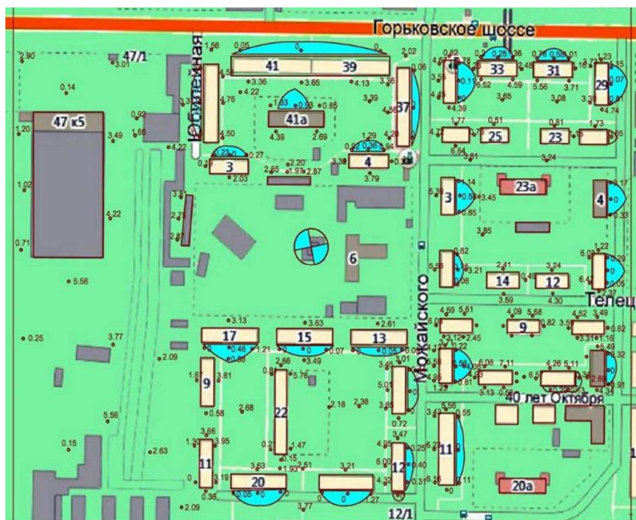
Рисунок 4 - Карта электромагнитных полей жилой застройки с указанием изолиний плотности потока энергии (ППЭ) при частоте 2,45 ГГц вблизи от телебашни (9.00-18.00/пятница/март) ( 0-1 мВт/см 2 ; - 2-9 мВт/см 2 ; 10-14 мВт/см 2 )
