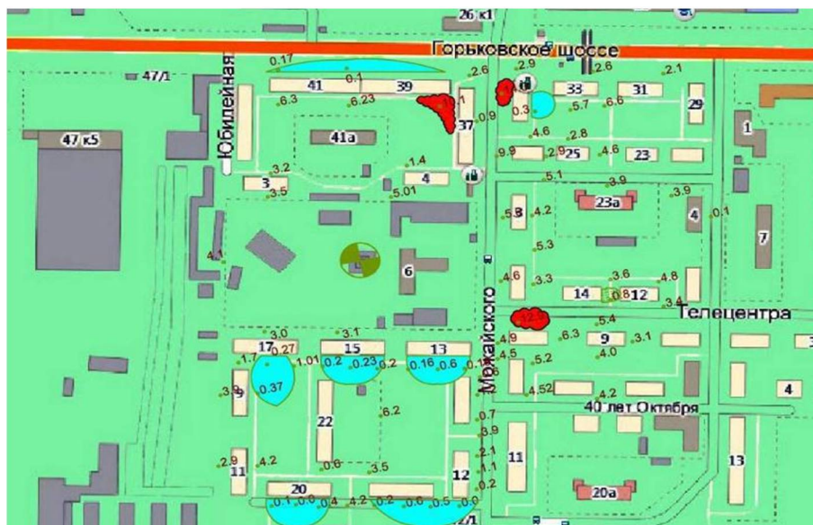
Рисунок 3 - Карта электромагнитных полей жилой застройки с указанием изолиний плотности потока энергии (ППЭ) при частоте 1,0 ГГц вблизи от телебашни (9.00-15.00/воскресенье/март): ( 0-1 мВт/см 2 ; - 2-9 мВт/см 2 ; 10-14 мВт/см 2 )
