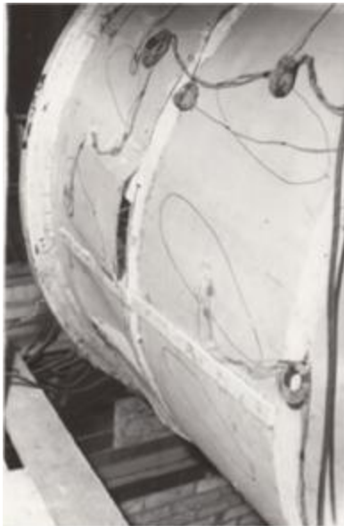
Рисунок 4 – Формы разрушения оболочки. Вырывающий эффект складок
