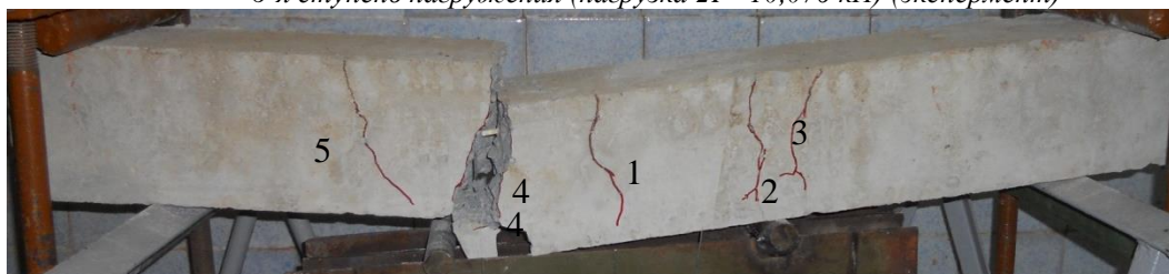
6-я ступень нагружения через 2 минуты, разрушение (нагрузка 2F=10,076 кН)
