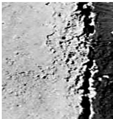
Рисунок 1- Трещина в бетоне на контакте с металлом в опытных образцах
