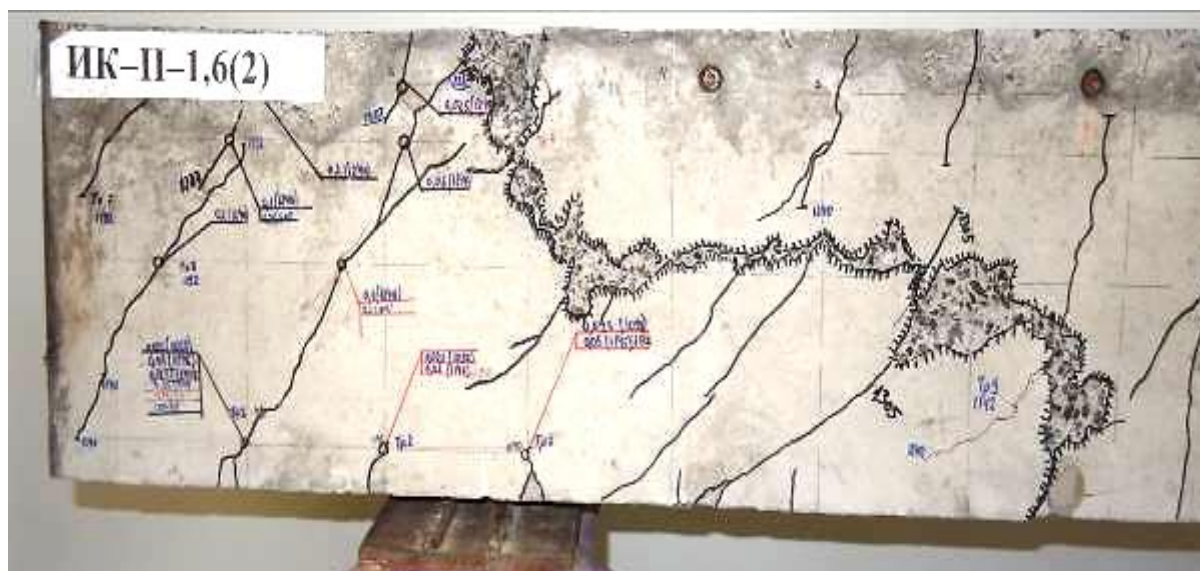
Рисунок 5 – Картина образования и развития трещин при проведении испытаний железобетонных конструкций второй серии на кручение с изгибом
