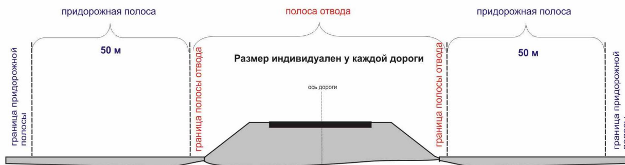
Рисунок 2 – Схема расположения полосы отвода и придорожных полос для автомобильных дорог (на примере третьей и четвертой категорий)
