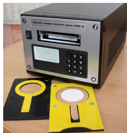
Рисунок 2 – Радиометр дочерних продуктов радона «АТЛЕШ-1М»
