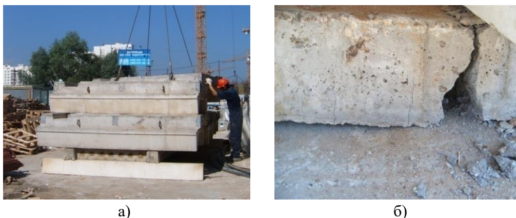
Рисунок 7- Процесс испытания плит (а) и фрагмент разрушения (б)
