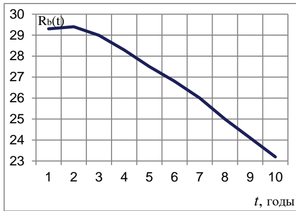
Рисунок 3 - График зависимости изменения прочности бетона R_b(t) от времени t (годы)
