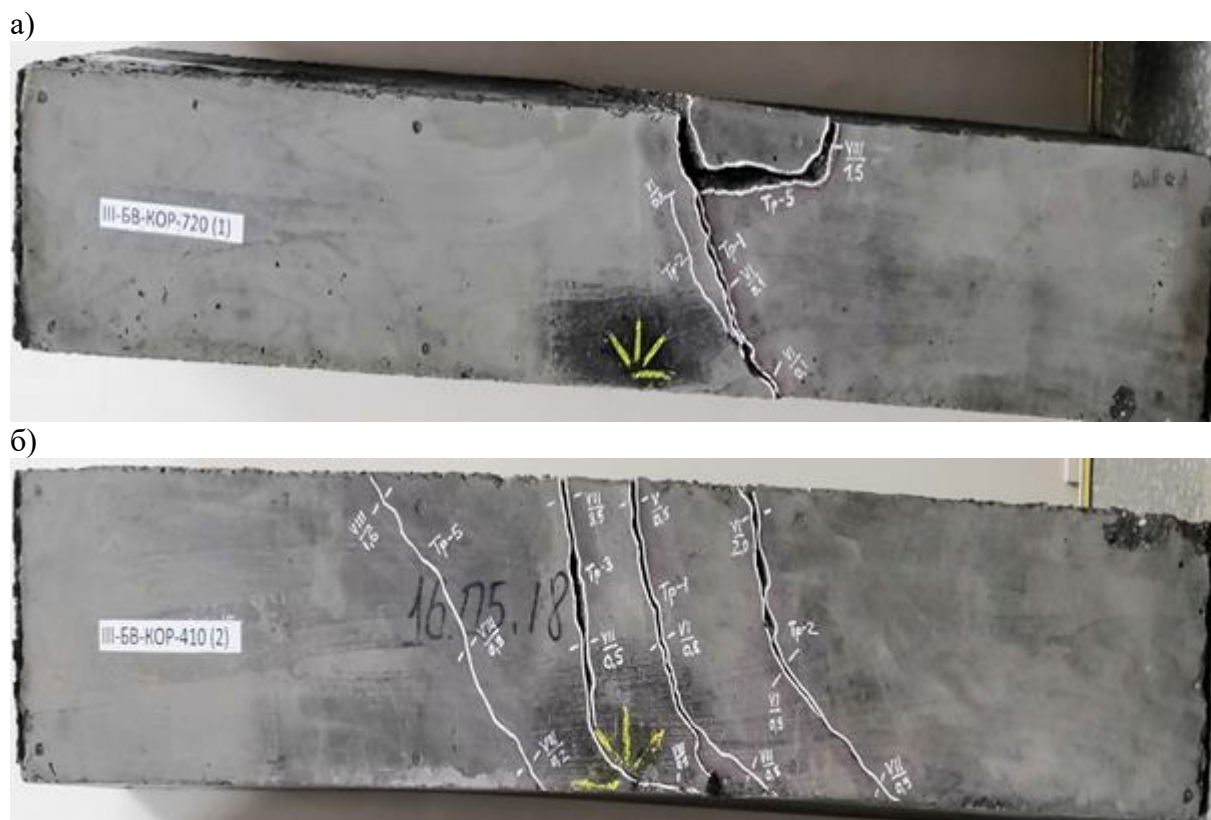
Рисунок 1 – Картина образования и развития трещин при проведении испытаний железобетонных конструкций из высокопрочного бетона на кручение с изгибом: сторона А: а – III-BB-KOP-720 (1); б – III-BB-KOP-410 (2)
