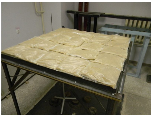
Рисунок 3 – Моделирование равномерно распределенной нагрузки
