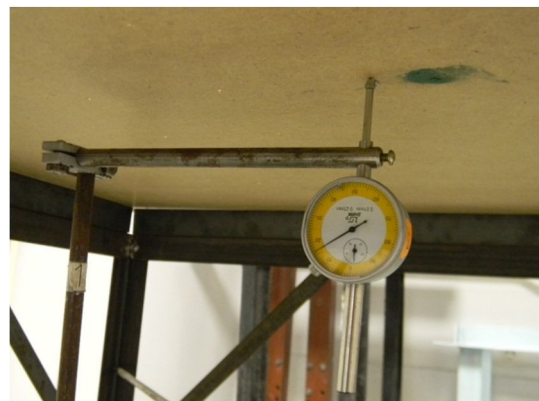
Рисунок 4 – Индикатор часового типа ИЧ-25
