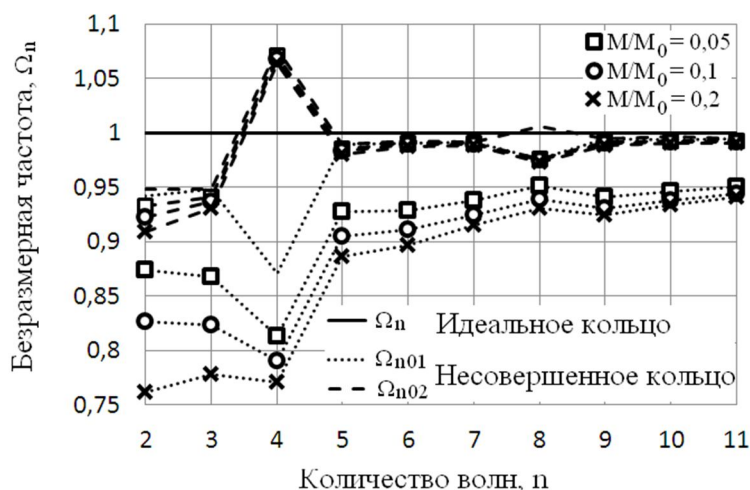
Рисунок 4 – Максимальное расщепление частотного спектра (угол крепления массы 35^\circ )
