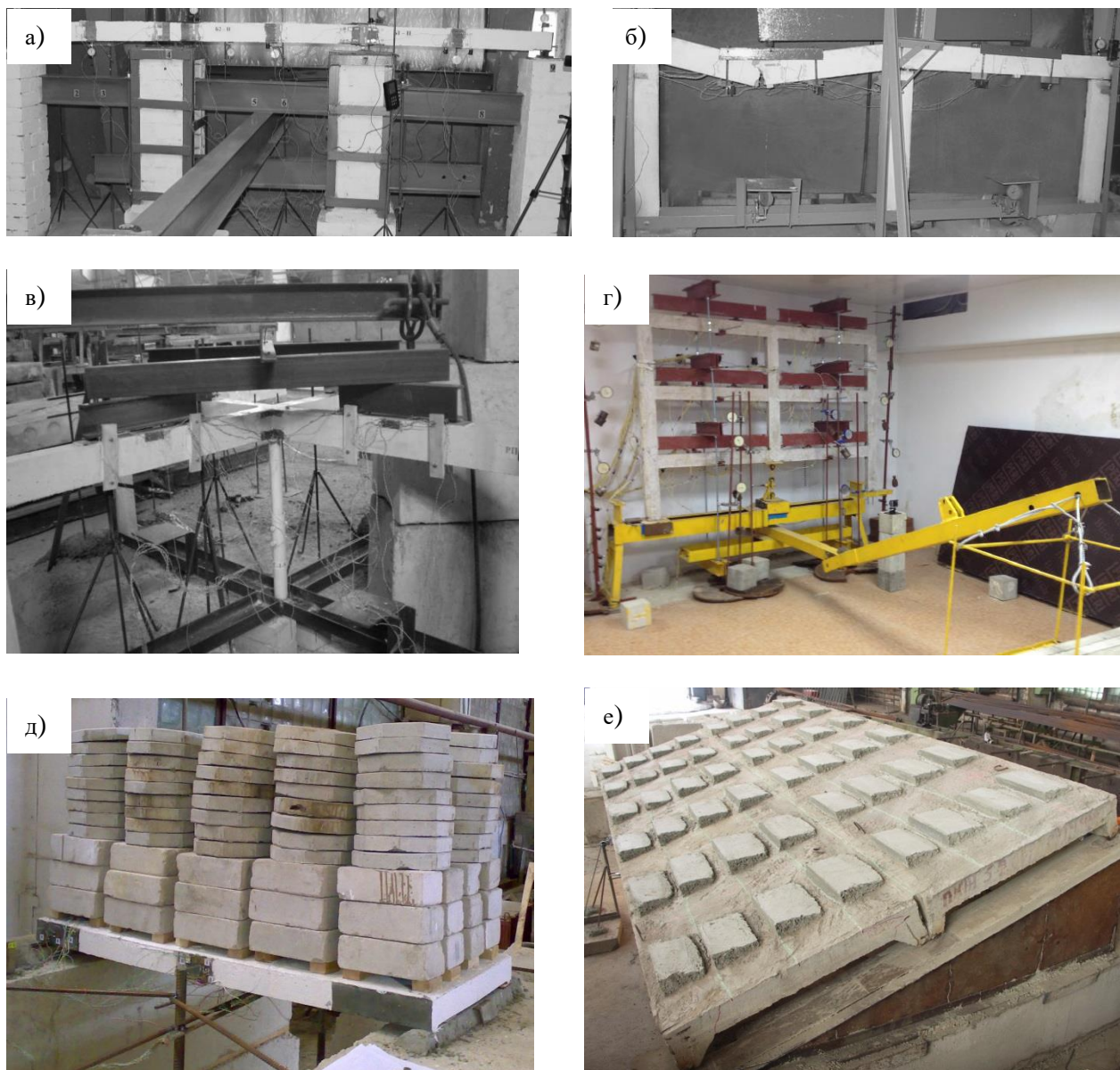
Рисунок 3 – Экспериментальные исследования железобетонных конструкций в России при аварийных воздействиях - общий вид испытаний: многопролетных балочных конструкций сплошного и составного сечения (а); плоских рамно-стрессневых конструкций сплошного и составного сечения, в том числе с преднапряженным ригелем (б); многоэтажной монолитной рамно-стрессневой конструктивной системы (в); фрагмента пространственной рамно-стрессневой конструкции (г); модели ребристой плиты (д) и фрагмента призматической складки (е)
