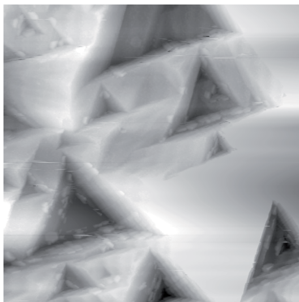
Рис. 8. АСМ-изображение структуры ямок травления.
