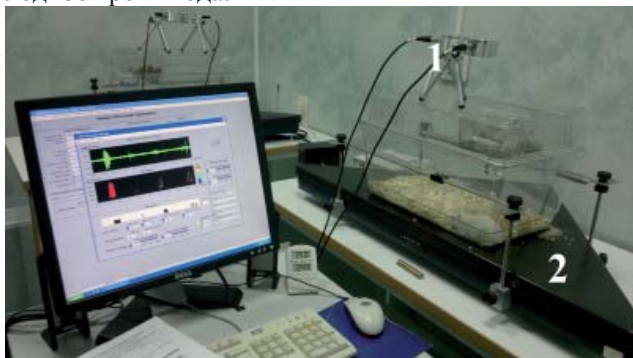
Рис. 1. Совмещённые системы SONOTRACK(1) и LABORAS(2) при синхронной записи. Общий вид.
