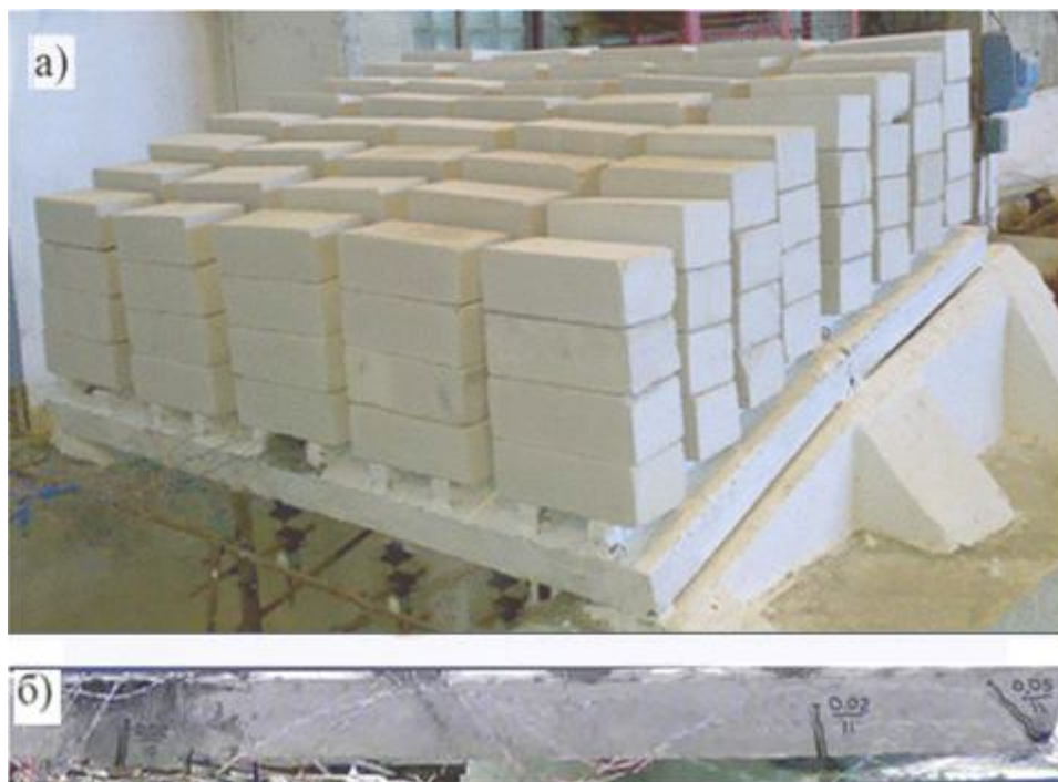
Рисунок 2 – Испытание модели складки: а – общий вид испытания, контроль прогибов с помощью индикаторов часового типа; б – трещинообразование в крайнем нижнем ребре
