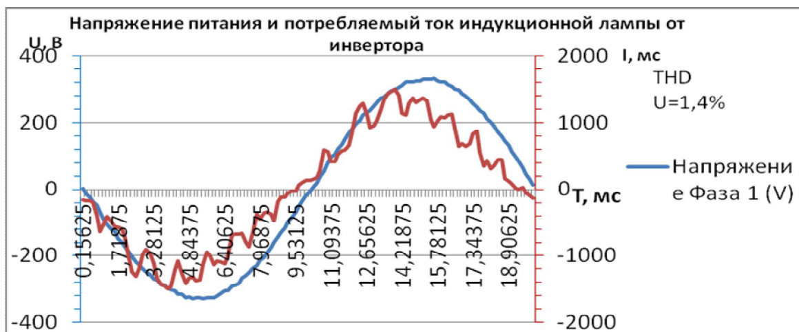
Рис. 3 - Напряжение питания и потребляемый ток индукционной лампы, подключенной через инвертор
