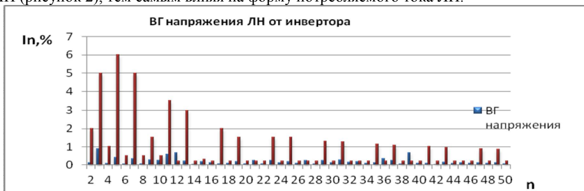
Рис. 1. Гистограмма ВГ напряжения ЛН. Подключенной через инвертор, и сравнение с допустимыми значениями по ГОСТ 13109-97
