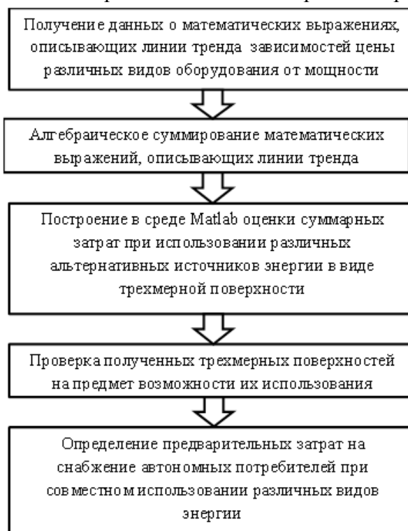
Рис. 1. Алгоритм определения предварительных затрат на снабжение автономных потребителей при совместном использовании различных видов энергии
