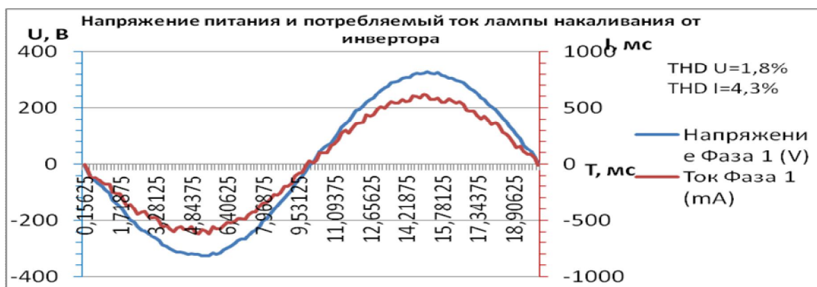
Рис. 2. Напряжение питания и потребляемый ток ЛН, подключенная через инвертор
