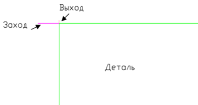
Рисунок 1 – Технологический прием: увеличение длины захода на контур детали для исключения появления расслоения на детали
