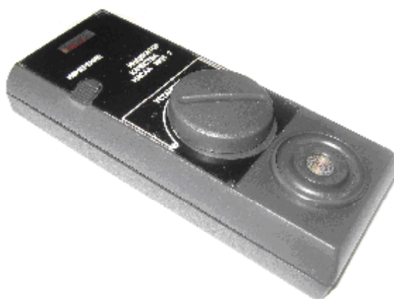
Рисунок 3 – Экспресс-анализатор качества работающих масел ИКМ
