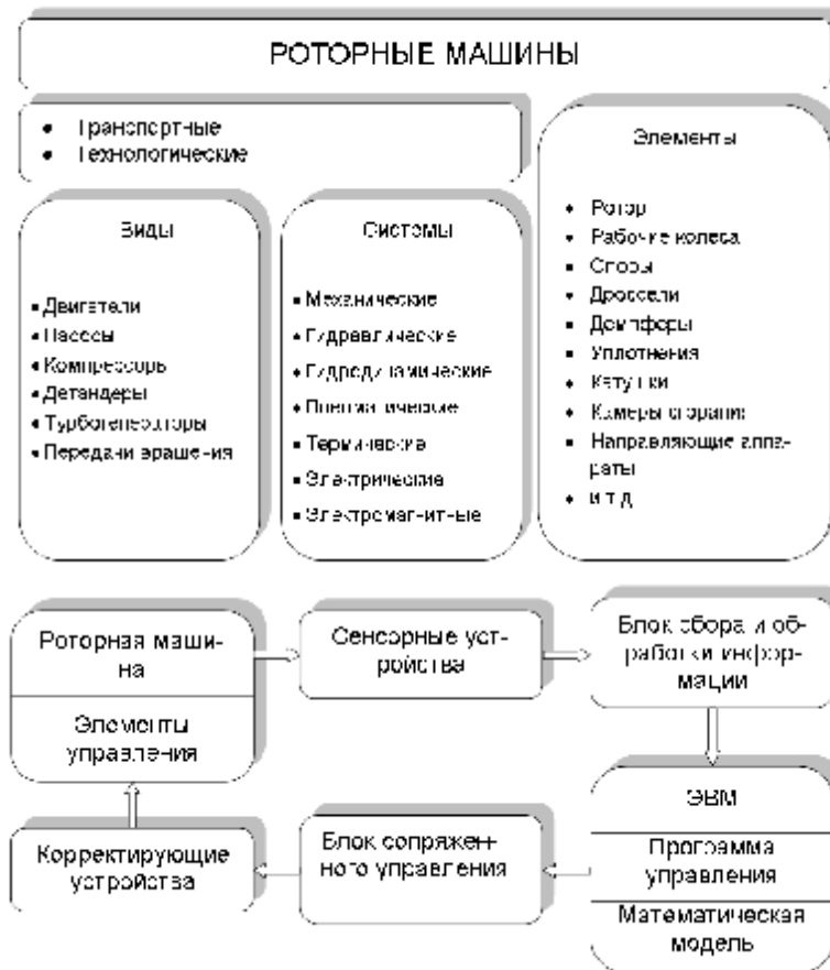
Рисунок 3 – Элементы и принципиальная схема активного управления в роторных машинах
