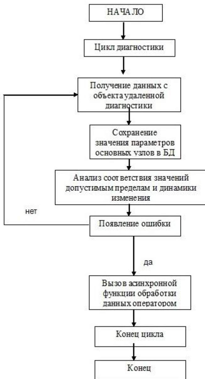
Рисунок 2 - Функциональная схема работы модулей приема и обработки информации
