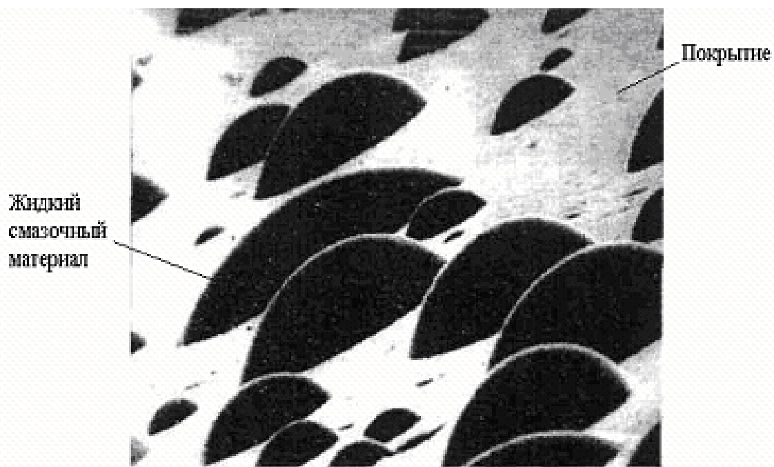
Рисунок 2 – Выделение смазочного материала из пор покрытия, 400 x
