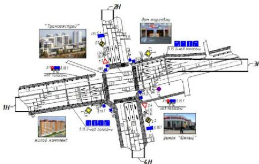
Рисунок 1 – Схема пересечения пр-та Ватутина – ул. Костюкова с обозначением въездных направлений
