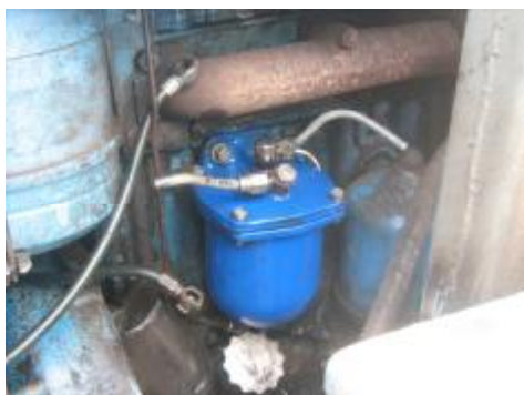
Рисунок 5 – Фильтр-нагреватель по патенту РФ (RU 2112582 CJ01Д29/48), установленный на двигатель
