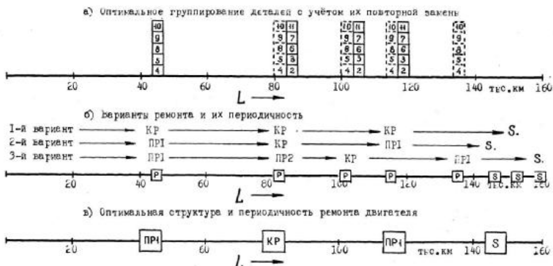
Рисунок 4 - Формирование структуры и периодичности ремонтного обслуживания двигателей ЯМЗ-240Н:
