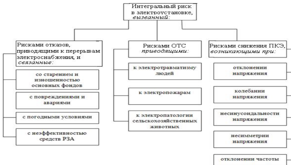
Рисунок 1 – Обобщенная структурная схема интегрального риска
