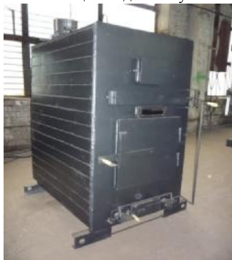
Рисунок 1 – Общий вид котла
