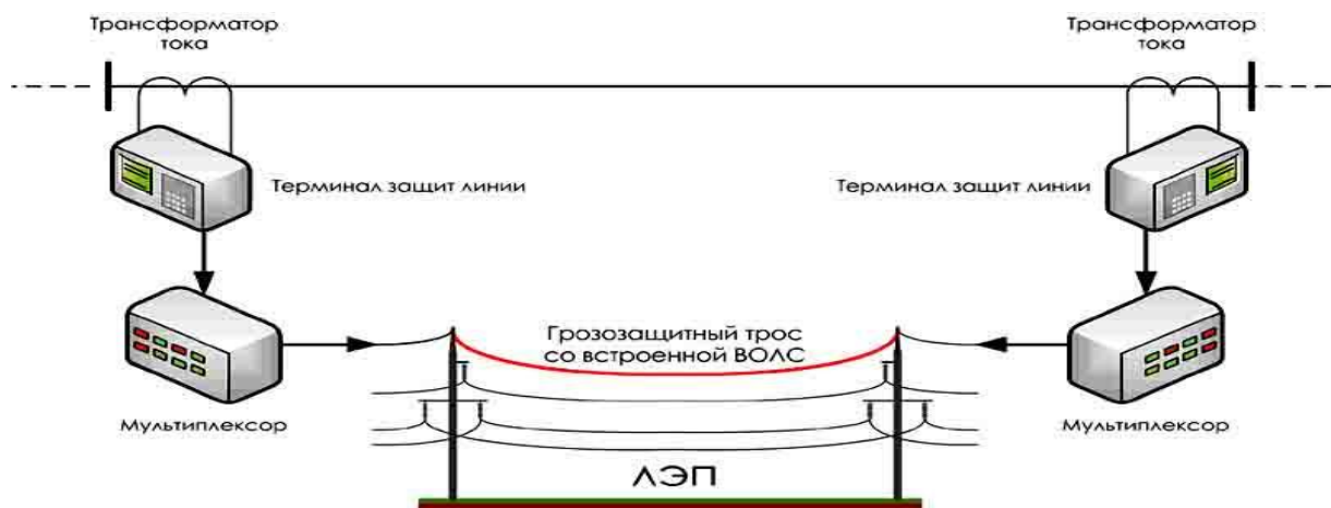
Рисунок 3 – Применение ВОЛС в продольных дифференциальных защитах линий
