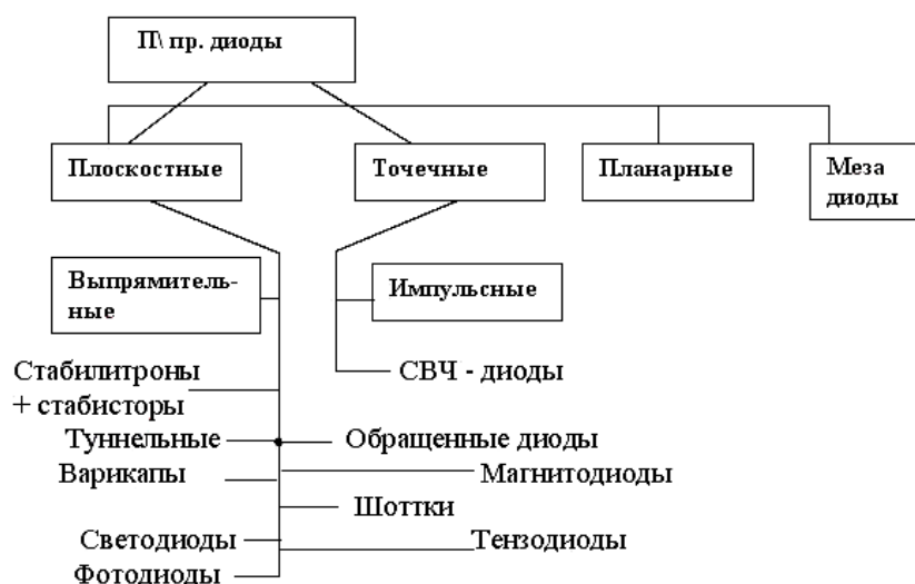
Рис. 1.19. Примерная классификация диодов
