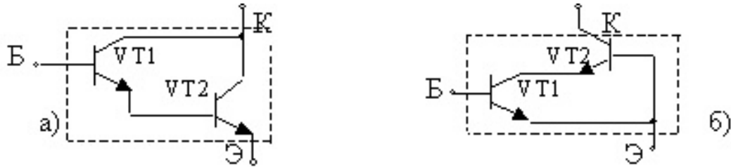
Рис. 8.18. Схемы составных транзисторов
