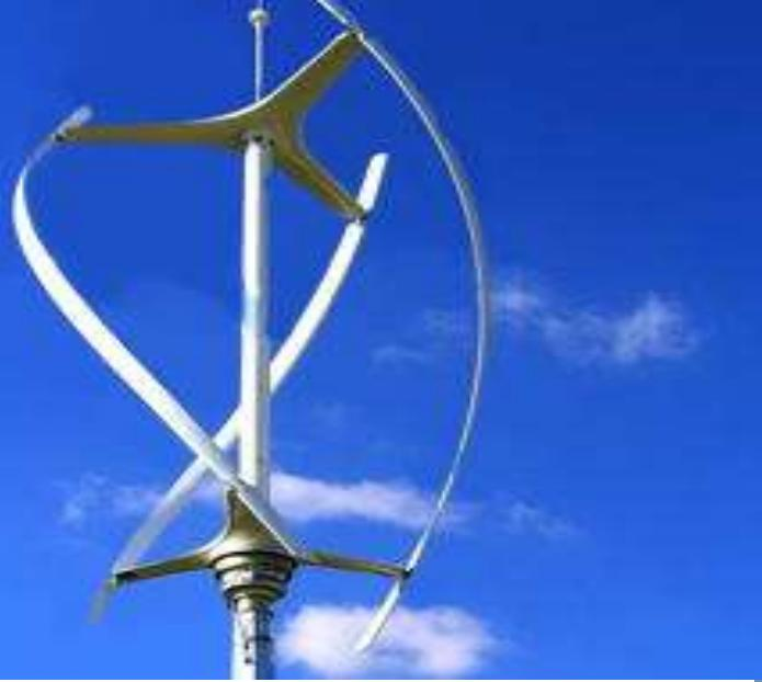
Вертикальные ветрогенераторы устойчивы к сильному ветру, могут выдержать даже ураганный ветер, для установки требуют минимум места под размещение фундамента мачты. Ветрогенераторы защищены от воздействия молний вследствие применения алюминиевой конструкции
