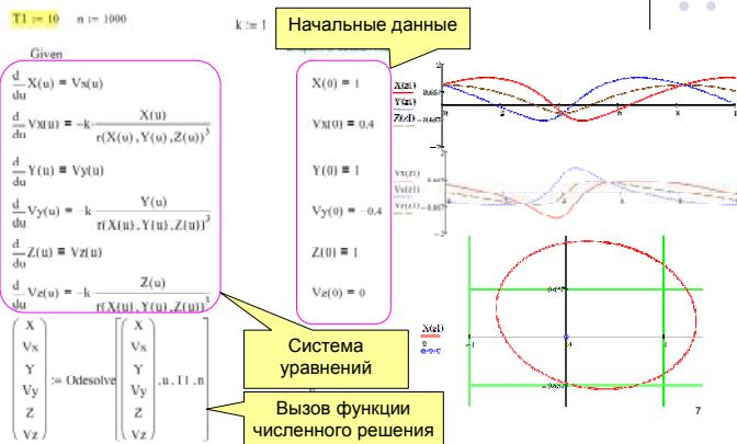
Для использования метода Рунге-Кутта мы преобразовали систему дифференциальных уравнений второго порядка в нормальную форму Коши, т.е. систему уравнений первого порядка путем добавления переменных  $dx/dt = v_x$ ,  $dy/dt = v_y$  и  $dz/dt = v_z$ .
